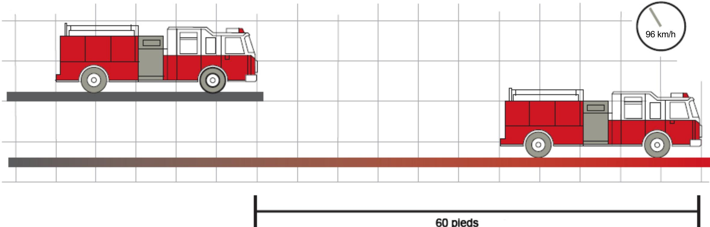
*Avec la suspension indépendante TAK-4 IFS, la distance de freinage est réduite de 60' pieds de distance comparé à un essieu rigide de même capacité*
