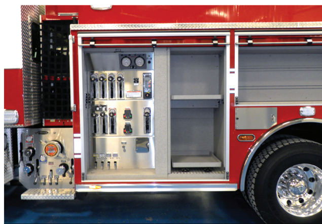
Panneau de pompe protégé et à l'abri des intempéries.
