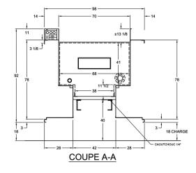
RESERVOIR EN COPOLYMERE 1500 GALLONS D'EAU 20 GALLONS DE MOUSSE
